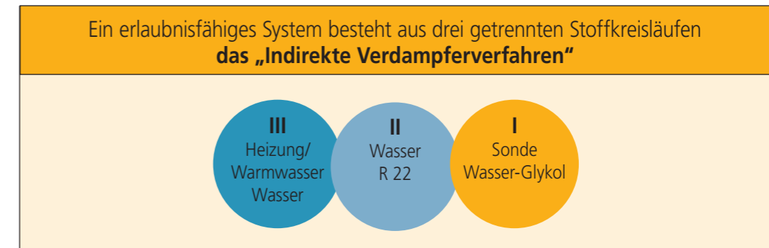
[Bild 19] System Erdwärmeanlage
